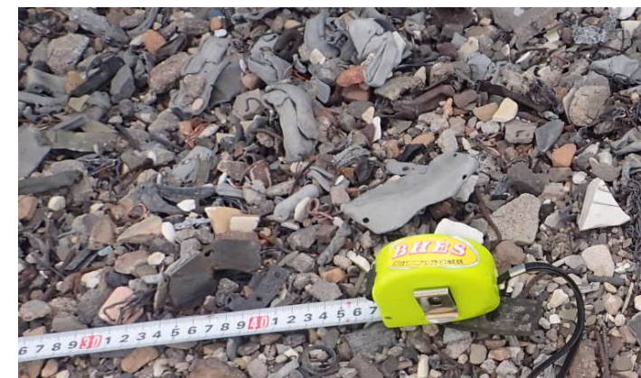
実機(建築廃材焚)における排出不燃物例
