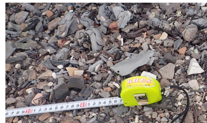
実機(建築廃材焚)における排出不燃物例
