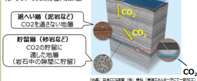
(参考1) CO 2 の貯留メカニズム
