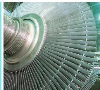
発電所のタービン動翼
